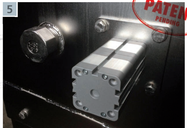
Dispositivo para la limpieza totalmente automática de los cribas en funcionamiento (patente en curso)
